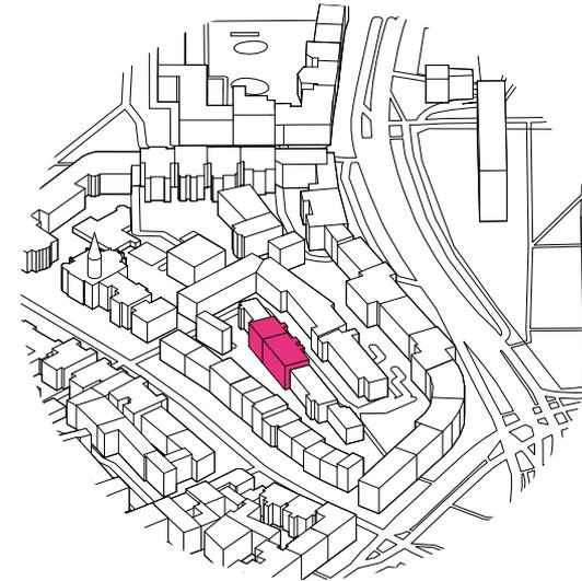
Ein fünfgeschossiges Bürogebäude aus den 60er Jahren wurde in Hamburg Havesterrude zu einem Wohnhaus umgebaut. Das Gebäude wurde komplett entkernt und ein zusätzliches Treppenhaus wurde eingebaut. An den Hoffassaden wurden Balkone angefügt und zu den Straßen hin Erker, in denen Küchen oder Bäder untergebracht werden können. Auf 2.973 Quadratmetern Bruttogeschossfläche schiefen blauraum architekten 15 Wohnungen mit 83 bis 144 Quadratmetern.
